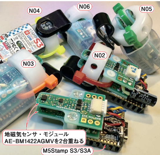
写真2 地磁気センサ AE-BM1422AGMV を 2 つと小型マイ コン M5Stamp S3 を 1 つのノードとして 16 並列する 2 台の磁気センサの平均値で遠方界、差分で近傍界に対応
