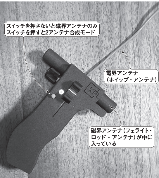
写真1 2つのアンテナを組み合わせて小型ながら高指向性を実現！自作3.5 MHz 受信機 電波を使った遊び…発信源を探して野山を走る「ARDF」用
