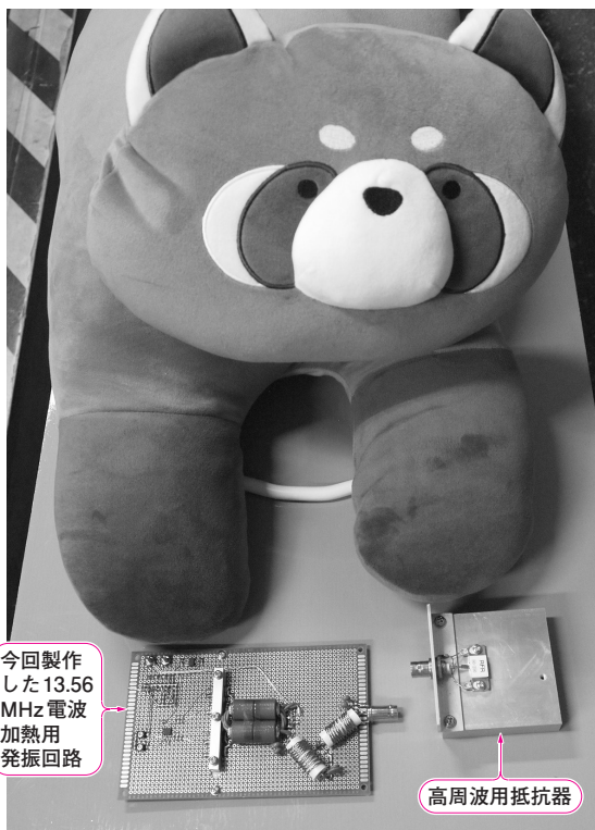
写真1 電波のエネルギー面を感じる...13.56MHz加熱実験 ぬいぐるみに発熱体を仕込み、高周波をあてて加熱し、寒い日でも抱っこしてぽかぽかを楽しめたらいい実験
