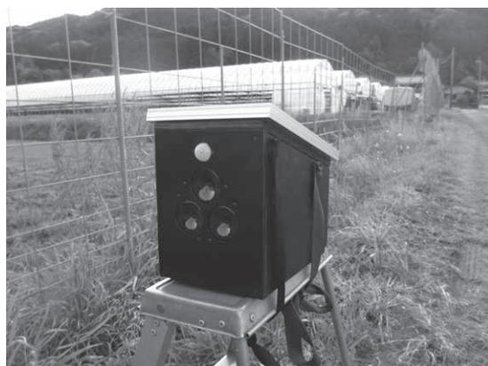
写真1 稼働中のソーラ式超音波害獣撃退マシン
