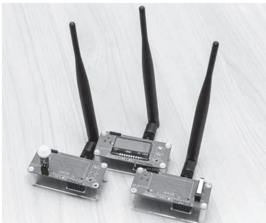
写真1 920MHz帯無線LoRaを使って遠隔センサ・モニタを製作する
