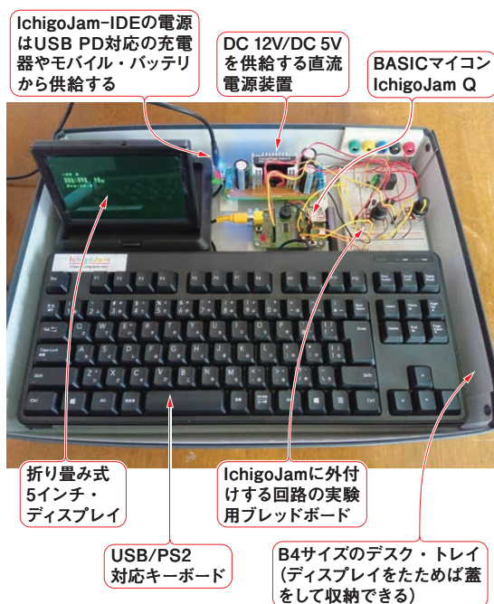
写真1 製作したBASICマイコン電子回路実験ベース…「IchigoJam-IDE」と名付けた モニター、キーボード、電源装置、ブレッドボードをB4サイズに統合して「思いついたらすぐ試せる」環境を作った
