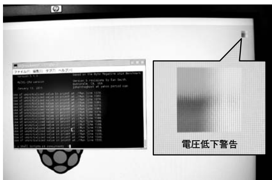
写真1 Raspberry Piの電源電圧低下警告 長いUSBケーブルや電流能力不足のUSB-ACアダプタを用いると頻繁に表示される
