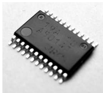
写真2 電圧補正機能付きスイッチング・レギュレータNJW4119 Raspberry Pi3の公称電流は2.5Aなので、熱設計の観点からスイッチング・レギュレータを選択
