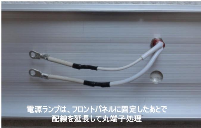
電源ランプの配線は短いため半田付けして延長します。
