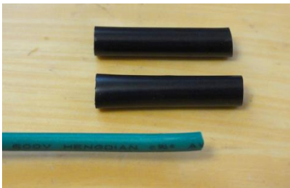
配線の剥きシロを切る
