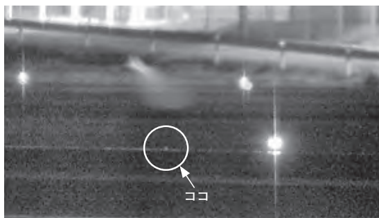
写真2 異物はレーダで検出され、物体付近の画像が取得できる
