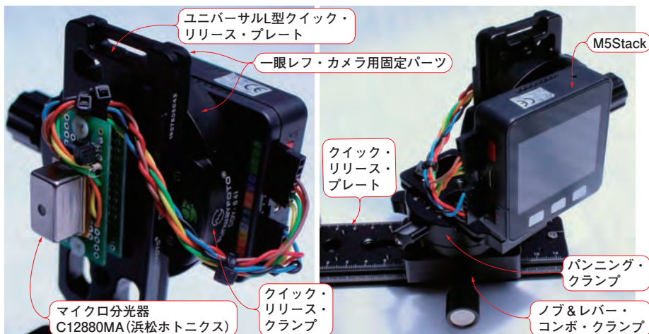
(a) M5Stackと分光器の取り付け部
