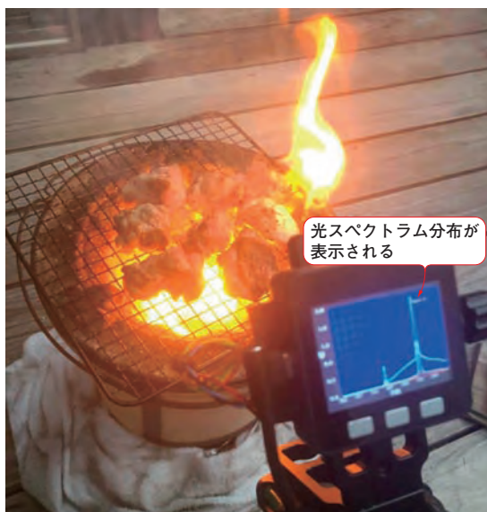
写真2 油が落ちて炎があがったときのスペクトラムを測定しているところ
