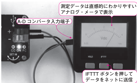
写真1 M5Stackで作ったネット対応版アナログ電圧計は、内蔵A-Dコンバータで測定したデータを電圧に変換し、Googleスプレッドシートにデータを記録する
