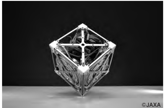
写真1 コーナ立ちして静かに倒立し安定する1辺が10 cmの立方体「3軸姿勢制御モジュール」の制御メカニズムを考察
