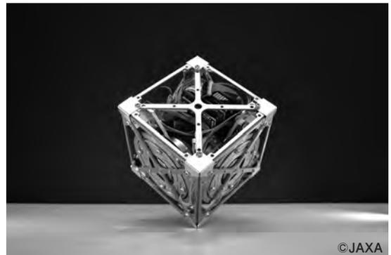
写真1 コーナで立ちして静かに倒立し安定する1辺が10 cmの立方体「3軸姿勢制御モジュールの制御メカニズムを考察
