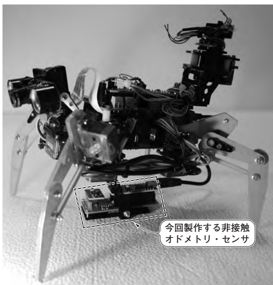
写真1 4足歩行ロボットに自身の移動量を計測するオドメトリ・センサを追加する 非接触なのでロボットの走行に支障を与えない。前後左右は光学マウス・センサ、旋回は地磁気センサでそれぞれ計測する
