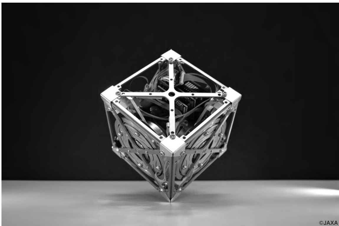
写真1 点立ちして静かに倒立する3軸姿勢制御モジュール(開発 JAXA)
