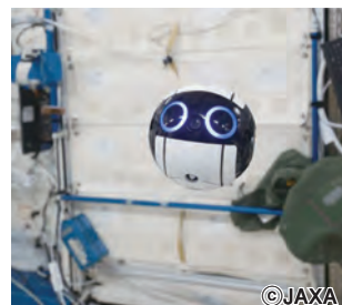
写真3 写真2の姿勢制御モジュールよりさらに小型なものが組み込まれている宇宙ロボット Int-Ball カメラも搭載している。地上から国際宇宙ステーションの中を観察しながら、自在に移動したり、姿勢を変えたり、作業者に移動指示を出したりできる
