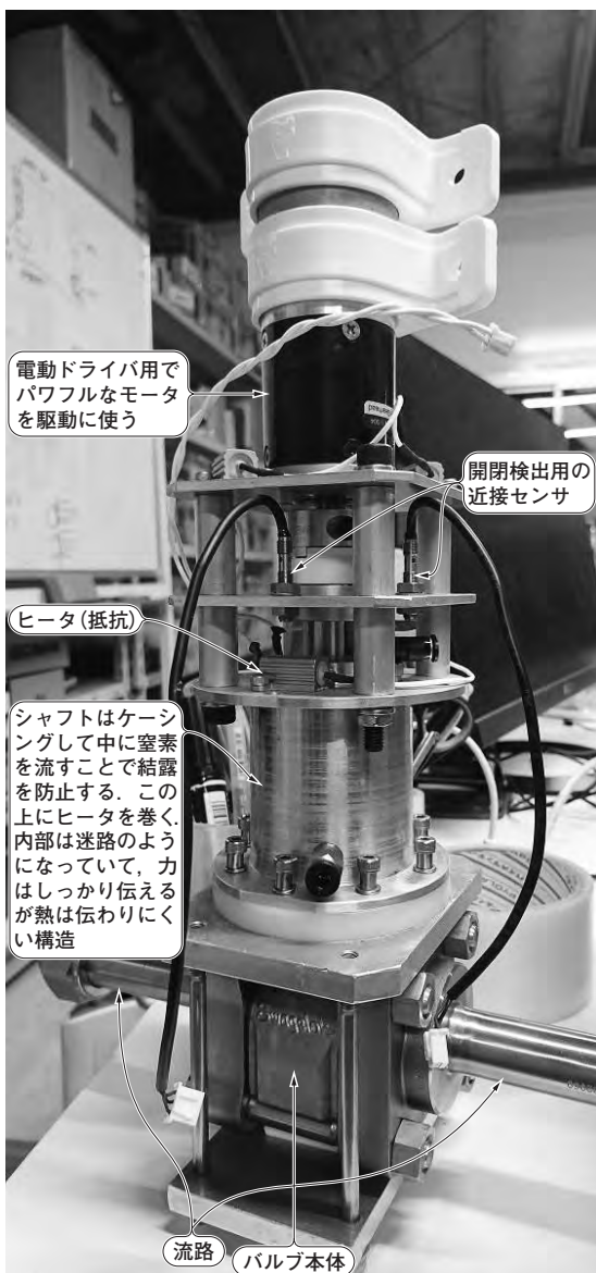
写真1 液体酸素の流量制御に使っている電動ボール・バルブの構造
