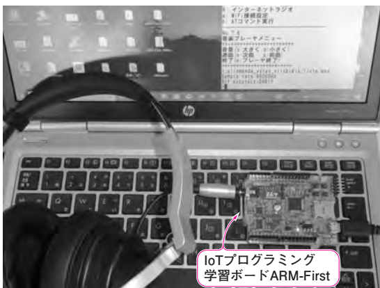
写真1 IoTプログラミング学習ボードに搭載されているSTM32F405RGマイコンならCPUパワーやメモリ・サイズも十分あり、MP3ソフトウェア・デコードが可能である
