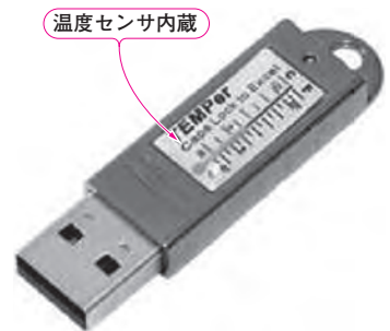
写真2 市販のUSB温度センサ「TEMPer」をお手本に学ぶ Web上にたくさんの情報があるので動作の解析がしやすい
