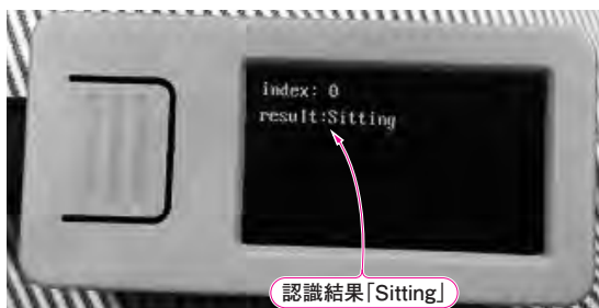
写真1 M5StickVを使ってアクティビティ認識を実行したようす 認識結果「Sitting」が表示される
