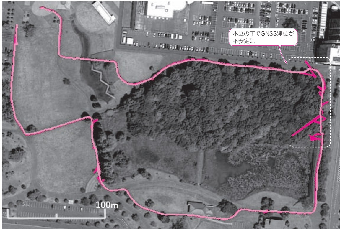
図1 拡張カルマン・フィルタによる位置推定軌跡は、木立の下以外でのGNSSの測位結果とほぼ一致した 拡張カルマン・フィルタによる位置推定軌跡(桃色)とGNSSの測位結果(赤色)。Google JPから写真引用
