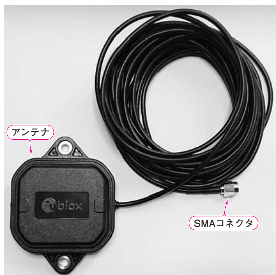
写真1 ユーブロックス社推奨の2波長対応アンテナ トラ技2周波RTKスタータ・キットにも同梱されている
