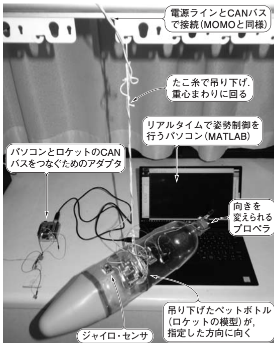
写真1 吊り下げたロケットの模型(MOMO Jr.)の向きをMATLABから制御する
