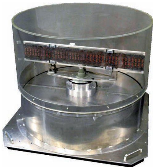
写真1 自分で電波を出してターゲットを捕捉するアクティブ・レーダ
