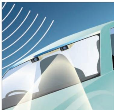
**第1章** 被写体の形/動き/相対速度を17msで超高速計測
