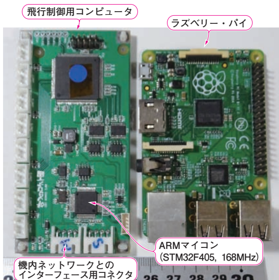
写真1 MOMO2号機に搭載されている主コンピュータはARMマイコン
