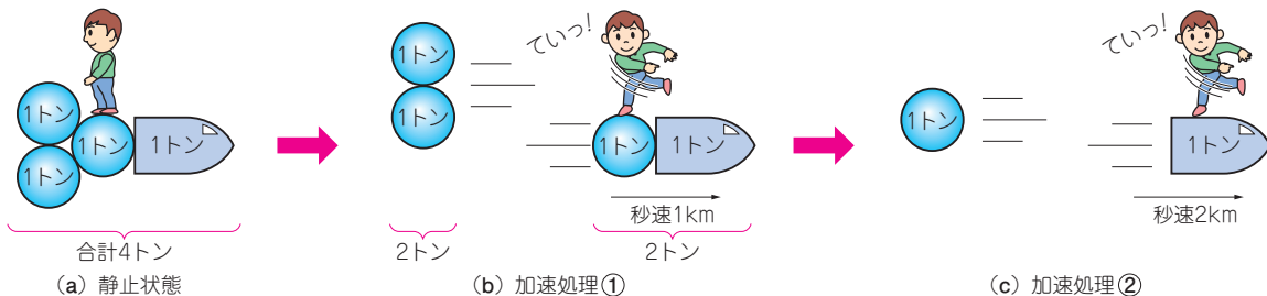
宇宙船を秒速2kmに加速するには、アンディにまず2トン、次に1トンのボール(=推進剤)を投げてもらわなければならない
