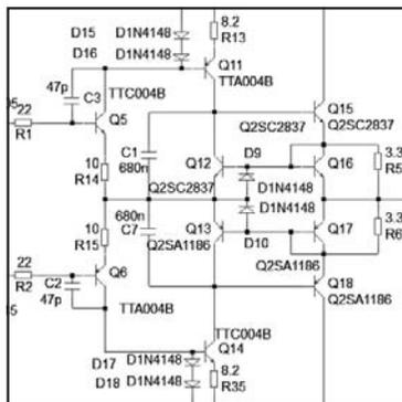
超低雑音 OP アンプ採用！大振幅時でも全出力トランジスタがノンスイッチング動作
