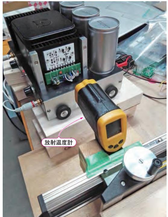
写真3 放射温度計をxyテーブルに取り付けて、アルミとFR-4で作った2つのパワー・アンプ基板の表面温度を測った
