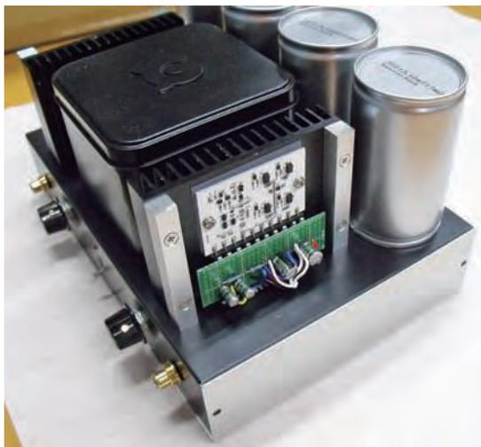
写真2 アルミ基板ベースのハイブリッド・パワー・モジュール2枚を使って、連続出力10Wのオーディオ・アンプを製作
