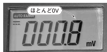
(b) 反転入力端子 V_{in-} の測定値
