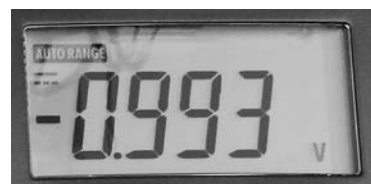
(c) 出力電圧 V_{out} の測定値
