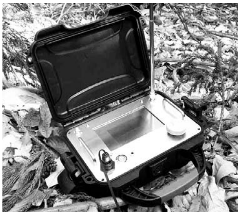
(a) ラズベリー・パイ3, 2 GHz Pi レシーバ拡張ボード(図(b)), ケース, HDMI入力液晶パネル, 穴あけ加工済みパネル, その他部品一式をセットにした「Piラジオ」
