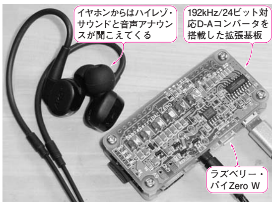
写真1 ラズベリー・パイZero Wを使って製作したWi-Fiハイレゾ・プレーヤ ラズベリー・パイZero Wと192 kHz/24ビット対応のD-Aコンバータ拡張基板で構成したオーディオ・プレーヤにAIテキスト音声読み上げ機能を追加した
