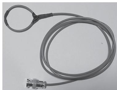
写真1 同軸ケーブルで作ったGHzプローブ
