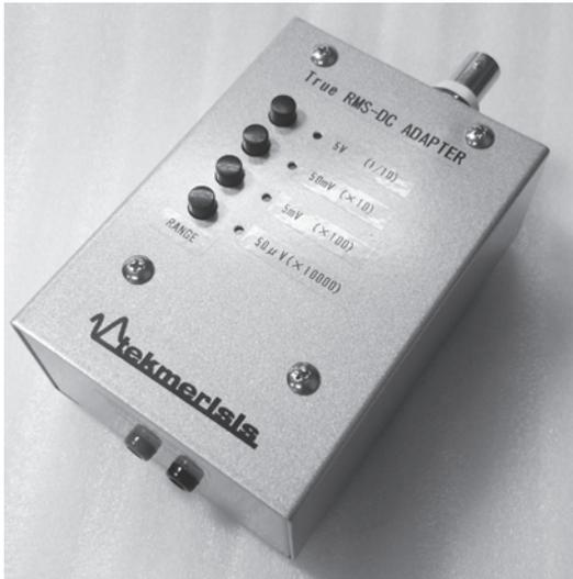
写真1 雑音でも音声でも！全波形対応の実効値振幅を測れる真の実効値プリアンプ
