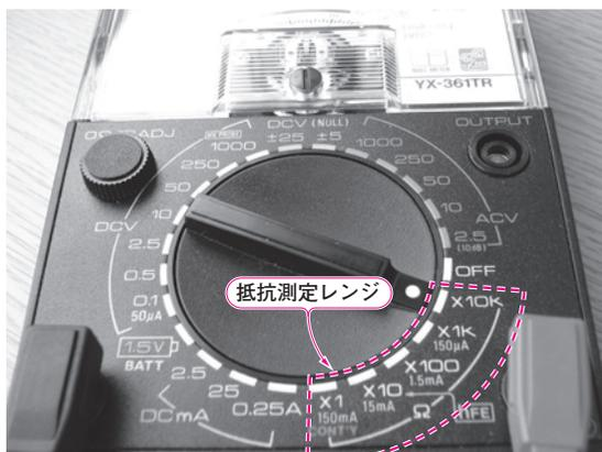
写真1 アナログ・テスタを抵抗測定レンジに設定すると、導通の有無や部品の抵抗値を調べることができる
