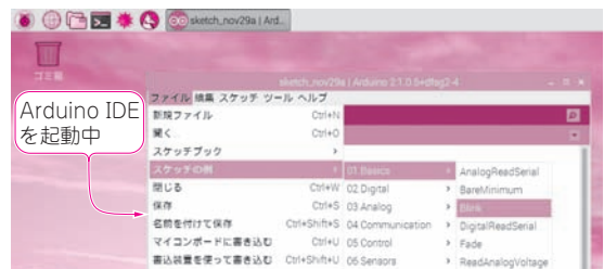
図1 ラズベリー・パイでArduino IDEを実行させたとときの画面 事前にシリアル・ポートの設定とArduino IDEのインストールが必要。 使い方はパソコンと変わらない
