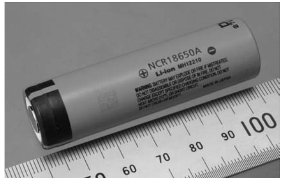
写真1 小型軽量で大容量! IoT電池の大本命リチウム・イオン蓄電池 電池電圧が3.6Vと高く、エネルギー密度はニッケル水素蓄電池の3倍!
