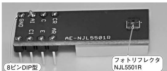
写真1 キー・パーツ! フォトリフレクタ「NJL5501R」搭載モジュール(秋月電子通商)
