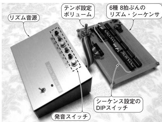
写真1 アナログ・ドラム音源ボックスと自動演奏シーケンサを手作り 6種類の音源を発音できる。シーケンサと組み合わせてリズム・マシンになる
