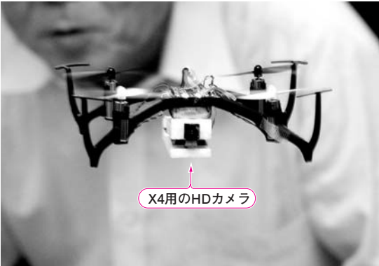
写真1 本稿の実験用ドローンReversi(Q4用モータ付き)にX4用のHDカメラによる空撮装置を装着
