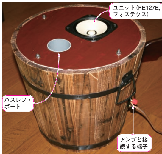
写真1 製作した木製プランタ・スピーカ(バスレフ型) バスレフ型エンクロージャ設計プログラムとMySpeakerを使用
