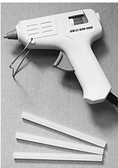
写真1 手芸や電子工作で使われるグルーガン・スティックと呼ばれる細長い円筒形の樹脂をヒータで加熱し、レバーを引いて押し出す
