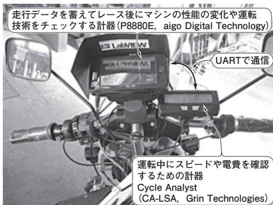
写真2 トラ技号に取り付けた二つの計器盤
