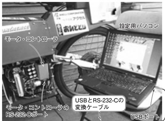
写真1 モータ・コントローラの動作を設定している
