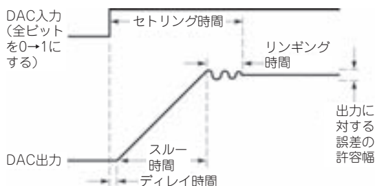
図1 D-Aコンバータのセトリング時間の定義
