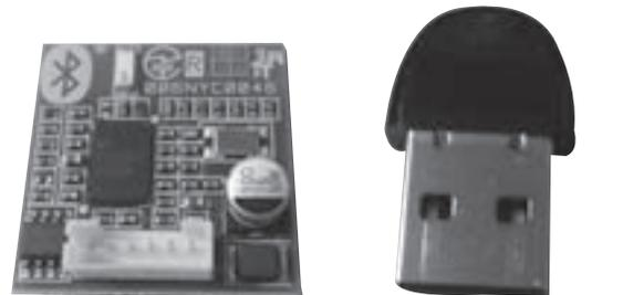
(a) シリアル接続タイプ (RBT-001) (b) USB Dongle・タイプ (BT-MicroEDR1)
