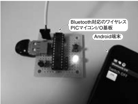
写真1 実験…Bluetooth接続でスマホと電子回路をつなぐ！
