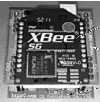
写真1 ARM Cortex-M0基板「MARY」による超小型ウェブ・サーバ
