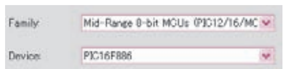
図3 新規プロジェクト作成手順③…ターゲット・マイコンを指定する
