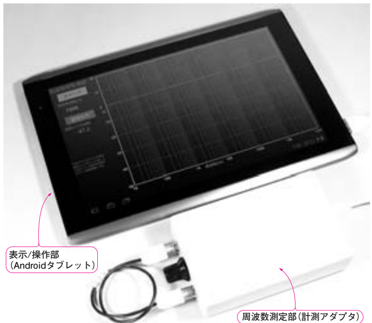
写真1 いつでもどこでも使えるポータブル周波数特性測定器を製作 タブレットICONIA TAB A500を使用する
